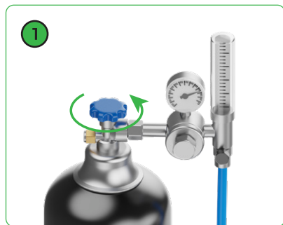
(1) Otworzyć zawór butli gazowej
